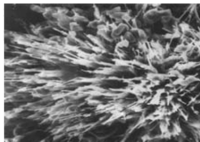
Những tinh thể tăng trưởng hoàn toàn sau 28 ngày trong vết nứt bê tông sau khi ngăn chặn luồng nước.
